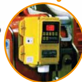
Limitador de carga eléctrico
